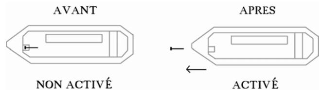
Positionner obligatoirement à plat ou verticalement sur l'objet à contrôler en faisant attention aux manipulations trop brusques et aux vibrations trop importantes. Si cela se produisait ne pas prendre en compte les petites taches dans la zone A
